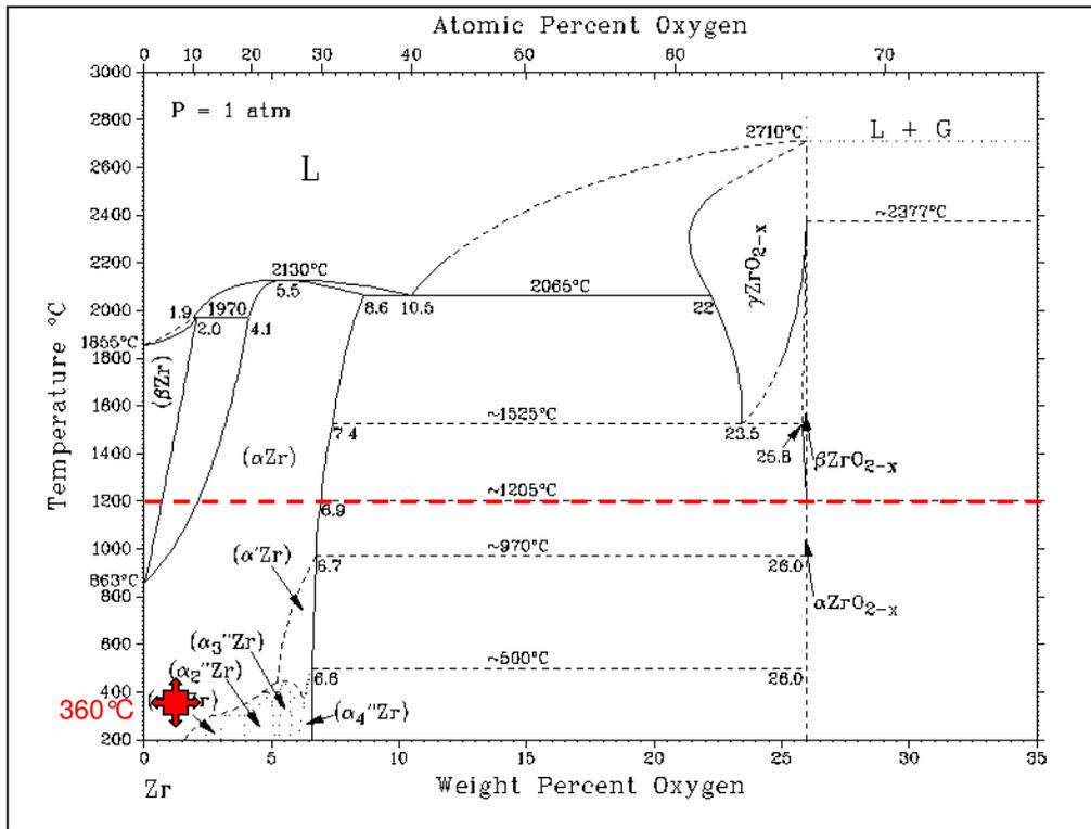
**Figure 1, Diagramme de phases binaire Zr-O [3].**
