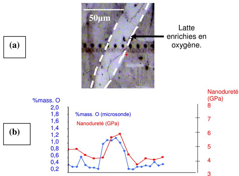
**Figure 5, Aspect local de la microstructure « ex β » du Zy-4 à 0,5%mass. oxygène, refroidi à 10 °C/s :**
