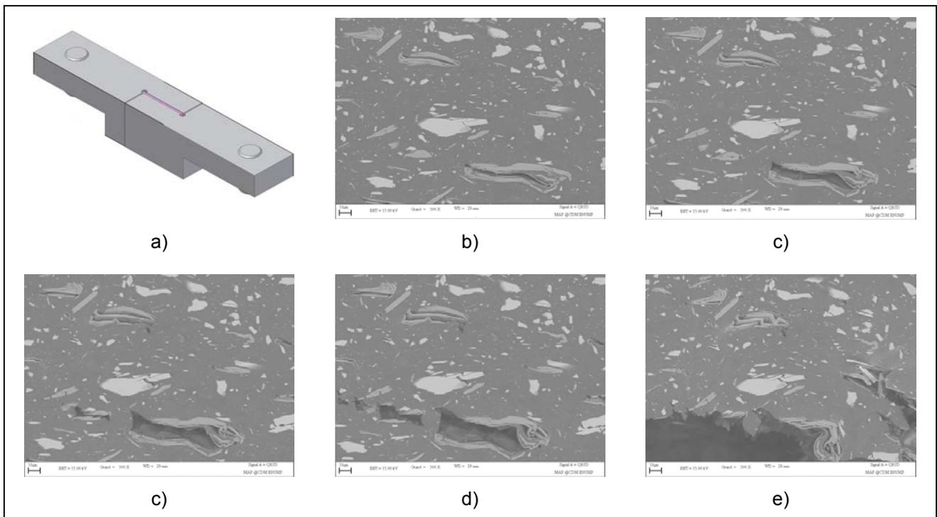
**Figure 3** Images MEB obtenues pendant un essai de cisaillement *in situ* sur assemblage (adhésif chargé). Eprouvette spécifique (a) et visualisation des mécanismes de déformations pour des sollicitations de cisaillement croissantes (b), (c), (d), (e) jusqu'à la rupture (f).
