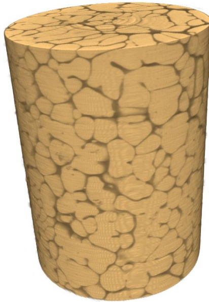
FIG. 2 – Représentation 3D d'un cylindre obtenu, pour le matériau ER1195, par la technique de microtomographie par rayons X au synchrotron de Grenoble à l'ESRF. La zircone est en jaune et la phase vitreuse en noir. Les dimensions du cylindre sont : 500 \mu\text{m} \times 500 \mu\text{m} \times 1433 \mu\text{m} (714 pixels x 714 pixels x 2048 pixels).
