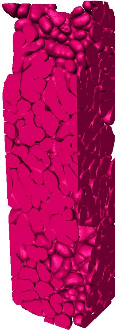
FIG. 3 – Connectivité de la zircone : représentation 3D des parties connexes de la zircone (dimensions : 350 \mu\text{m} \times 350 \mu\text{m} \times 1433 \mu\text{m} ).
