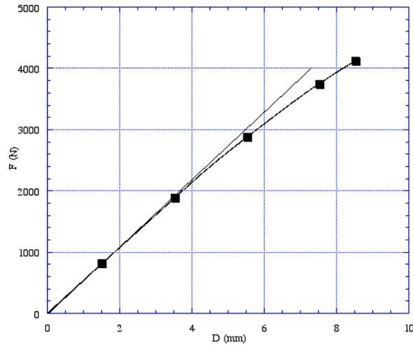
**Figure 6.** Courbe expérimentale force maximale ( $F$ , unité : N)/déplacement maximum atteint ( $D$ , unité : mm) aux points ( $B_{i=1,\dots,5}$ ) (figure 5)
