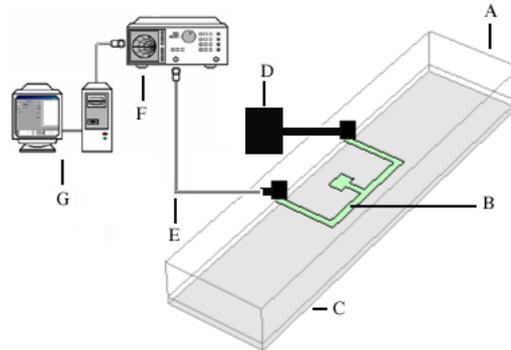
**Figure 1.** Schéma de principe d'un circuit microruban (A : substrat, B : ruban, C : plan de masse, D : charge  $Z_{charge}$ , E : câble coaxial, F : analyseur de réseaux, G : système d'acquisition des mesures)
