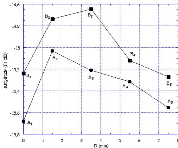
**Figure 7.** Amplitude du coefficient de réflexion (Amplitude (Γ), unité : dB) en fonction du déplacement maximum atteint (D, unité : mm) aux points (A<sub>i=1,...,5</sub>) sans charge et (B<sub>i=1,...,5</sub>) sous charge (figure 5) (Mesures à 2 GHz).
