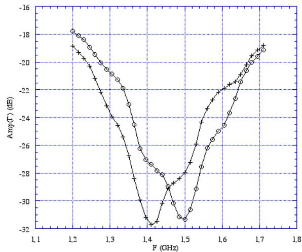
**Figure 2.** Amplitude de  $\Gamma$  ( $Amp(\Gamma)$ , unité : dB) en fonction de la fréquence ( $F$ , unité : GHz), o : circuit "type 0°", + : circuit "type 90°"
