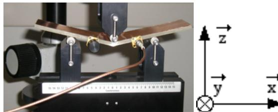
**Figure 3.** Dispositif de flexion
