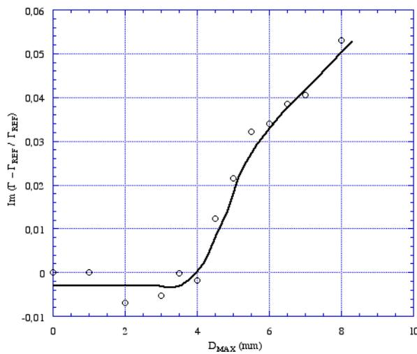
**Figure 8.** Partie imaginaire du coefficient  $\frac{\Gamma - \Gamma_{REF}}{\Gamma_{REF}}$  (sans unité) en fonction du déplacement maximum atteint ( $D_{MAX}$ , unité : mm) (Issues de mesures aux points ( $A_{i=1, \dots, 5}$ ) sans charge (figure 5)).
