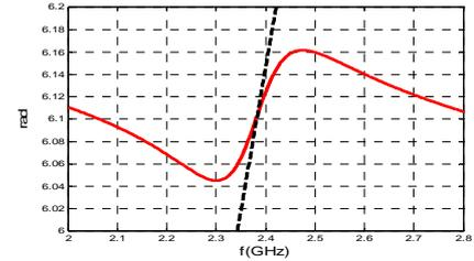
Nous constatons d'après la Fig.7, que la structure utilisant une SSR « combinée » offre une bande de fréquence plus large que celle d'une structure utilisant une SSR classique.
