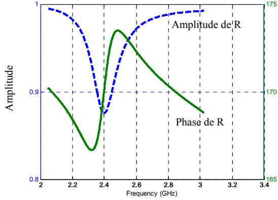
Fig. 5: Exemple d'une SSR combinée donnant une augmentation de phase du coefficient de réflexion
