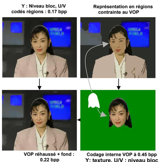
FIG. 5 : Principe de reconstruction de la forme du VOP et réhaussement de sa texture
