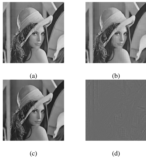
Figure 5 – (a) Image originale. (b) Image LAR. MICD classique : 6.17 bit par bloc (0.32 bpp), approche pyramidale : 5.47 bpb (0.33 bpp). (c) Image LAR post-traitée. (d) Image d'erreurs. (coût sans perte : 4.38 bpp).
