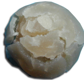
FIG. 3.8 – Apparition des fissures à la surface de la boule.
