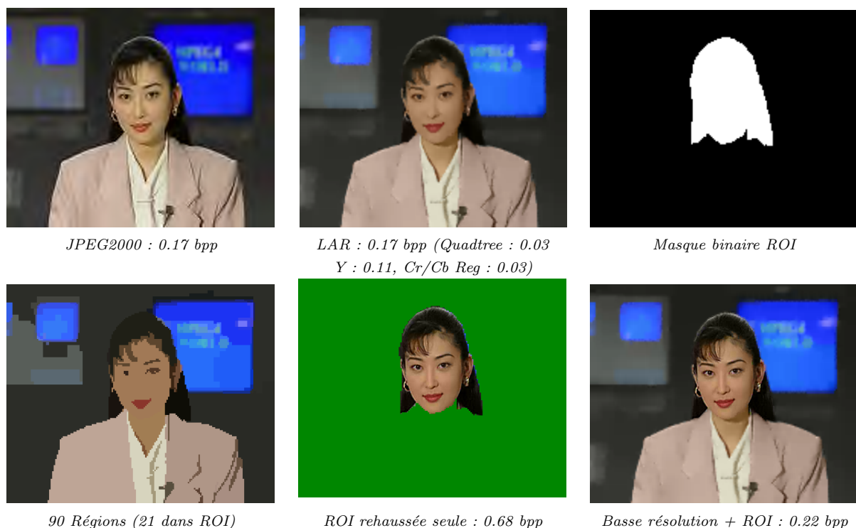
Fig. 14 : Codage par ROI sur image “Akiyo” avec contraintes de chrominance et masque binaire.
