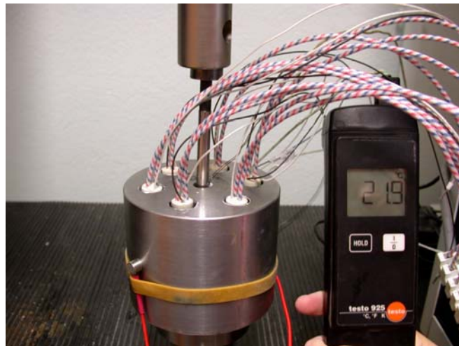
Photo 1. Matrice uniaxiale avec 6 trous cylindriques pour introduire les 6 carottes constituant le dispositif de chauffage. Un capteur piezo-électrique pour l'émission acoustique est visible sur la gauche.
