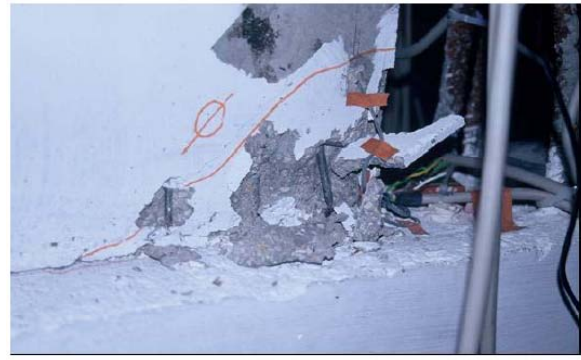
Figure 80- Fissuration et flambement de l'acier à la base du premier étage– essai T3
