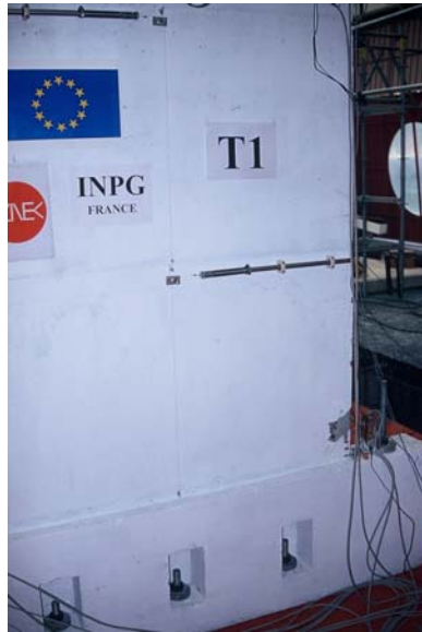
Figure 10- Maquette ECOLEADER : Mur XD après le test T1.
