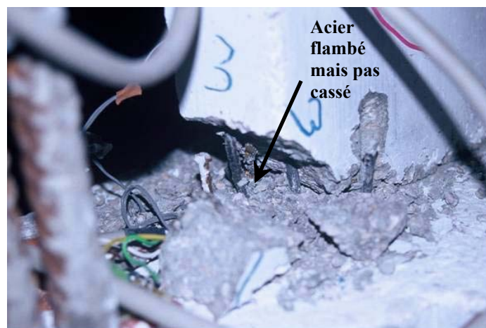
Figure 16- Maquette ECOLEADER : Mur XD après le test T5.
