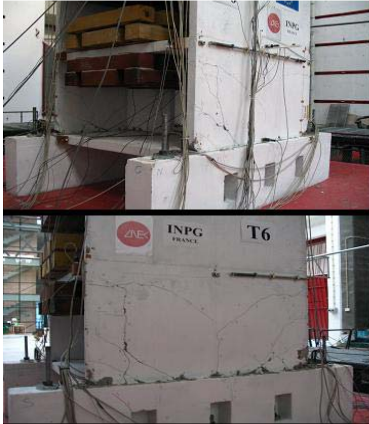
Figure 54- Maquette ECOLEADER : Etat de la maquette à la fin de l'essai (T6).
