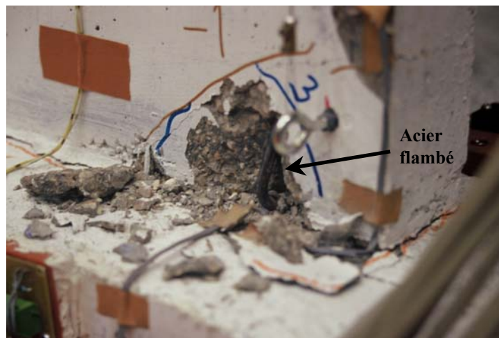
Figure 14- Maquette ECOLEADER : Mur XD après le test T3.
