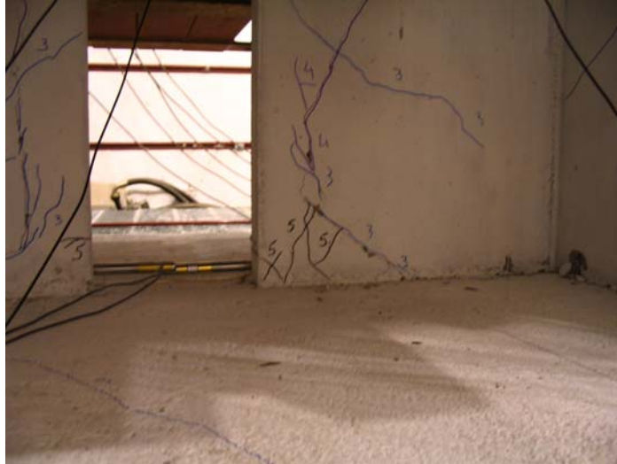
Figure 17- Maquette ECOLEADER : Mur Y après le test T5.
