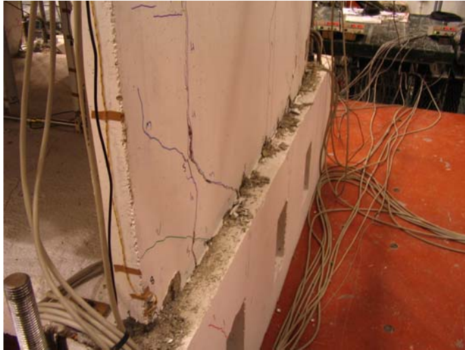
Figure 19- Maquette ECOLEADER : Mur XD après le test T6.
