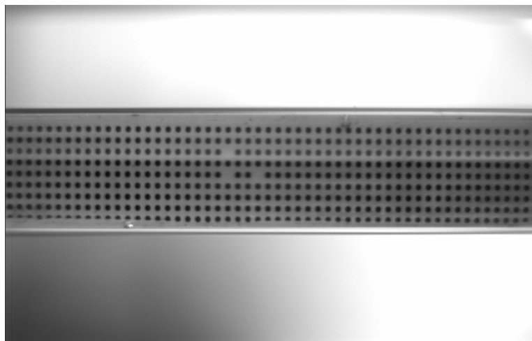
Figure 4 : Mire d'étalonnage du grandissement de la caméra.
