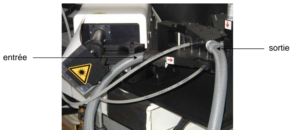
Figure 2 : Branchement de la maquette avec 6 tubes sur le banc hydraulique.
