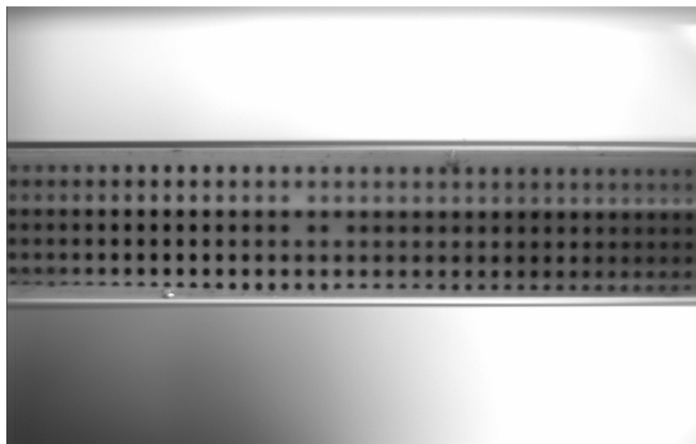
Figure 4 : Mire d'étalonnage du grandissement de la caméra.
