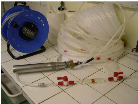
Photo 2 : système de pompage Grunfoss.
