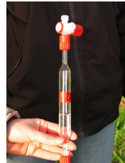
Photo n°4 et n°5 : ampoules de prélèvement en verre de 30 mL, en cours de remplissage.
