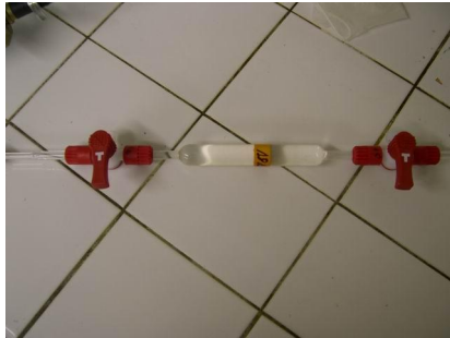
Photo n°4 et n°5 : ampoules de prélèvement en verre de 30 mL, en cours de remplissage.
