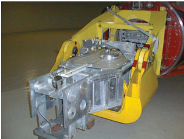
Figure 6. Simulation en centrifugeuse du comportement d'une pile de pont sur sol renforcé.
