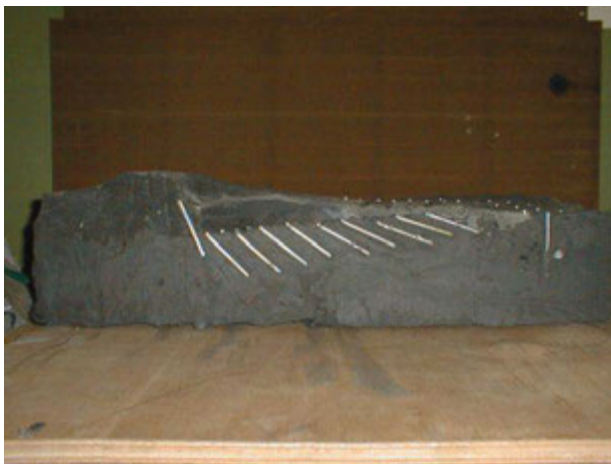
Figure 7. Mécanisme de déformation de la fondation renforcée d'une pile de pont après essai à la rupture.
