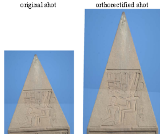
Fig. 3. Orthorectification of a photograph of the pyramidion of an obelisk (from [Parisel C., Rapport de travail sur la construction des orthophotos de surface à partir de photos en format BMP, GRCAO's internal research paper 17 p. (2004)]).
