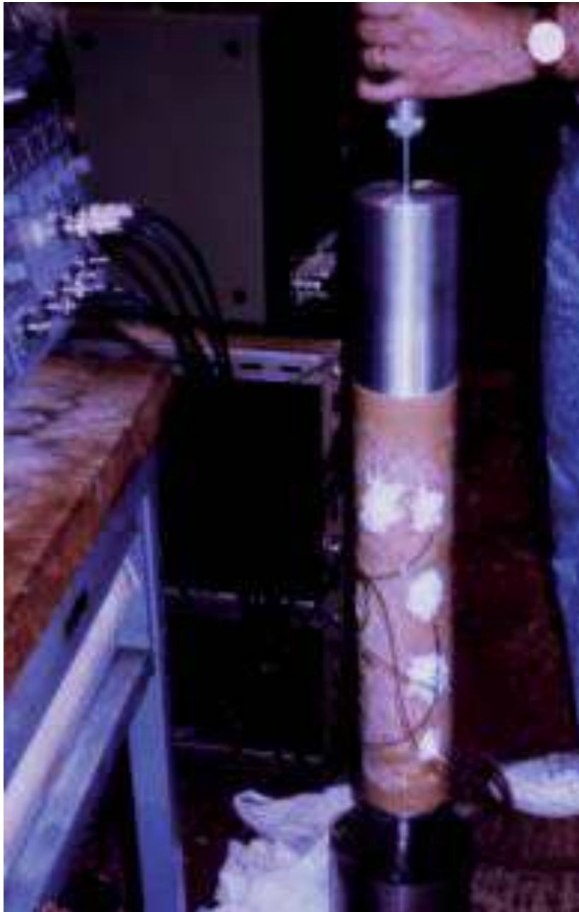
Figure 4.2.11. Propagation d'ondes longitudinales dans une colonne de sable dense de Fontainebleau
