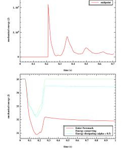
Fig. 6. Evolution of the ball mechanical energy through impact for midpoint, Euler-Newmark, energy conserving, and dissipating ( $\alpha = 0.5$ ) schemes. Evolution de l'énergie mécanique de la balle pour les schémas de point milieu, d'Euler, conservatif et dissipatif ( $\alpha = 0.5$ ).
