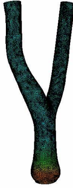
FIG. 1. A pressure wave inside an aortic bifurcation. Onde de pression à l'intérieur d'une bifurcation aortique.
