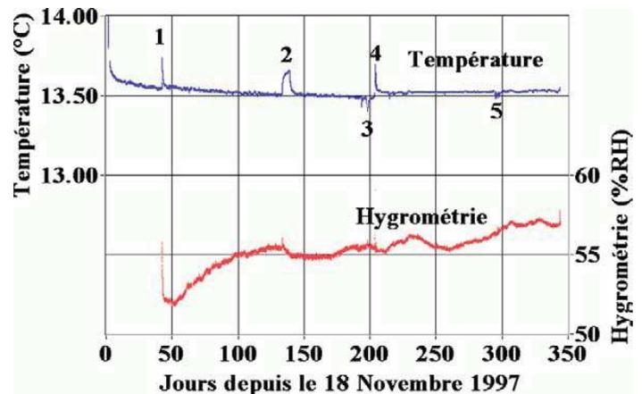
Fig. 1. Température et hygrométrie mesurées dans une galerie de la mine de Varangéville. Les accroissements de température (1) et (4) sont liés à la présence de personnes travaillant dans la galerie. Les diminutions (3) et (5) sont dues à des coupures de courant électrique. L'accroissement de température (2) est dû à une lampe électrique laissée allumée par erreur pendant 6 jours.
