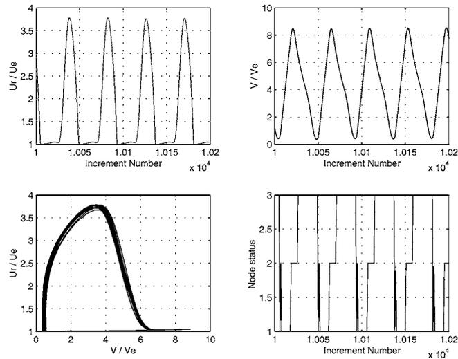
Fig. 2. Résultats numériques illustrant le mouvement d’un point matériel appartenant à la surface  $S$ . Cette figure donne la trajectoire, les déplacements radial  $U$  et tangentiel  $V$  ainsi que la nature du contact (1 = adhérence, 2 = glissement, 3 = décollement) au cours du temps (un incrément =  $1,35 \times 10^{-5}$  seconde). L’indice  $e$  se réfère à la solution de glissement stationnaire.
