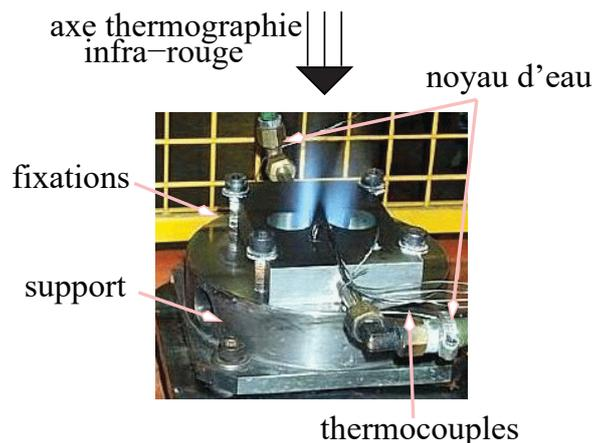
**Figure 10.** Plaque face-flamme sur le banc de mesure
