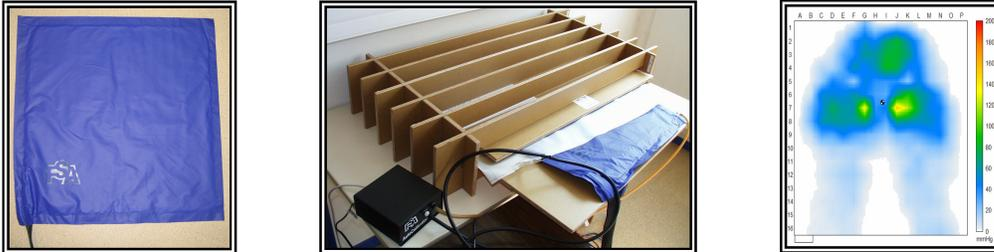
**Fig. 1 :** Présentation de la nappe de pression FSA de la société Vista Medical<sup>®</sup> (figure de gauche). Illustration du dispositif de calibration qui permet de calibrer la nappe par mise en pression à des étalons déterminés (figure du milieu). Illustration des pressions exercées par un sujet en position assise sur la nappe, avec hyperpression (zones de couleur jaune et rouge) au niveau des régions d'appui ischiatiques (figure de droite).
