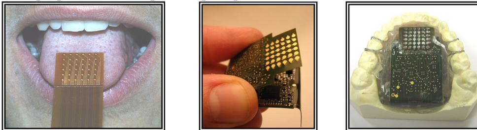
**Fig 2 :** La première version du Tongue Display Unit était filaire et incompatible avec une utilisation quotidienne (figure de gauche). Suite à un processus de miniaturisation (figure du centre), l'ensemble de l'électronique est noyée dans une orthèse palatine (figure de droite), qui laisse affleurer les 36 électrodes de stimulation linguale à sa surface inférieure. La communication du dispositif avec
