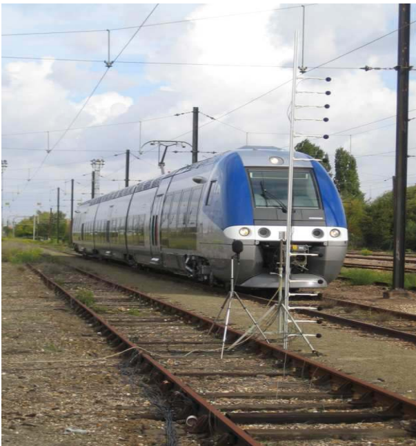
Figure 2: Passage de l'AGC devant le mât de microphones lors de la campagne de mesures.
