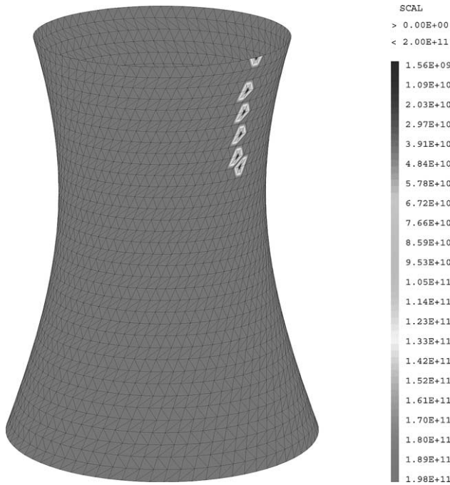
Fig. 2. Erreur en relation de comportement et vibrations libres (exemple synthétique) : maillage et carte de module d'Young montrant le défaut simulé.
