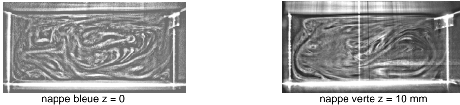
Fig. 8 Visualisation à un même instant de deux plans distants de 10 mm pour U_e = 1 \text{ m.s}^{-1}
