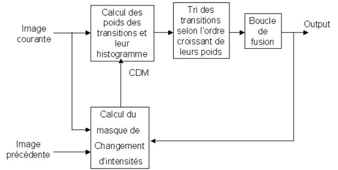
FIG. 2 – L’algorithme complet de la segmentation vidéo
