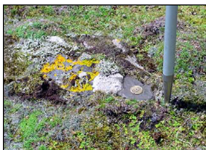
Photo 1 – Mise en place des points de calage et de mise en station sur l'île de Trielen (clou topographique en laiton scellé au mortier). Clichés S. Suanez
