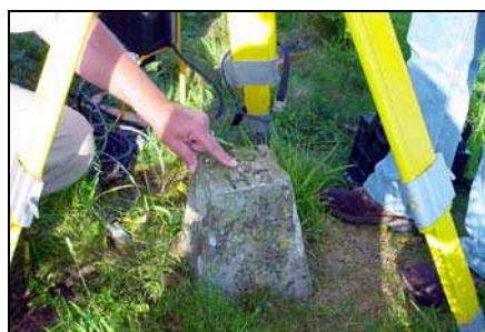
Photo 2 – Borne SHOM installée sur l'île de Molène et servant dans un premier temps de point de mise en station pour la station DGPS
