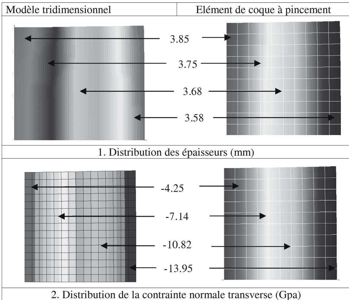
**Figure 14.** *Comparaison coque à pincement – tridimensionnel*
