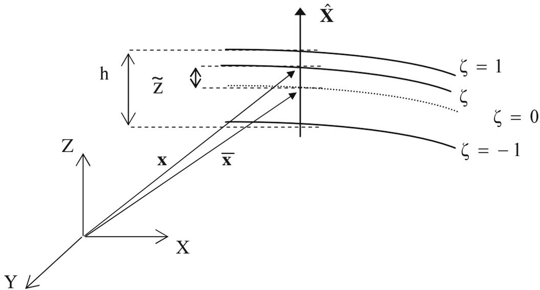
**Figure 5.** Géométrie de la coque
