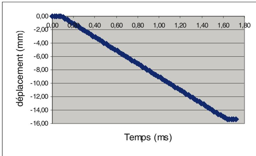
**Figure 21.** *Déplacement du poinçon au cours du procédé*
