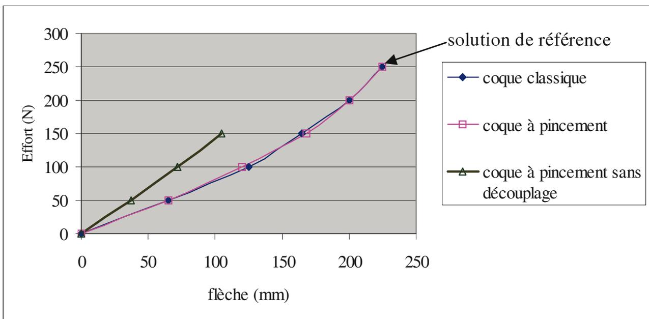
**Figure 18.** Comparaison des différents modèles. Poutre console
