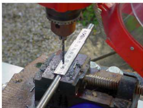
Etape 3 : rivetage des éléments de mètres aux tiges
