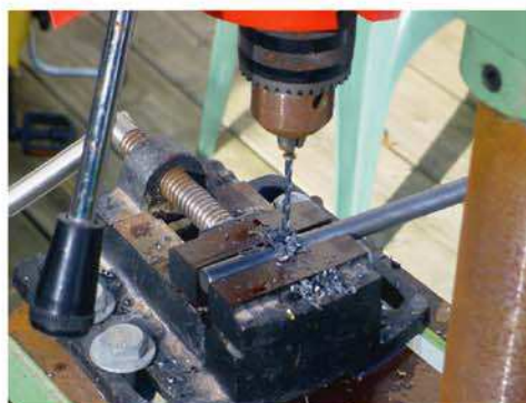
Etape 2 : perçement des tiges en acier
