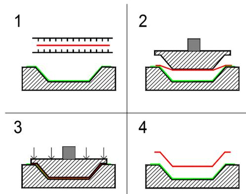
FIG 1. Etapes de la mise en forme des CFRTP- 1:Chauffage -2 : Mise en forme avec poinçon-matrice -3 :Etape de reconsolidation -4 : Retrait des outils
