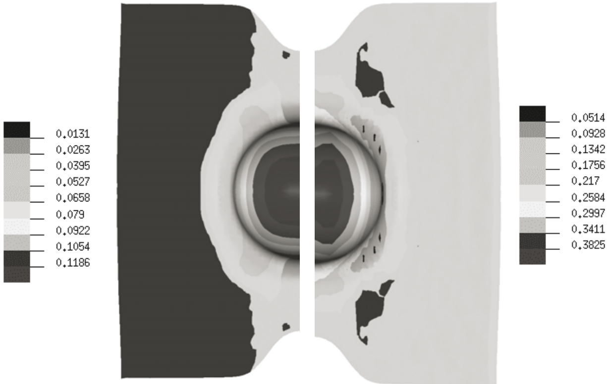
Figure 8. Tensions dans les mèches (en N/mèche), sens trame (à gauche), sens chaîne (à droite)
