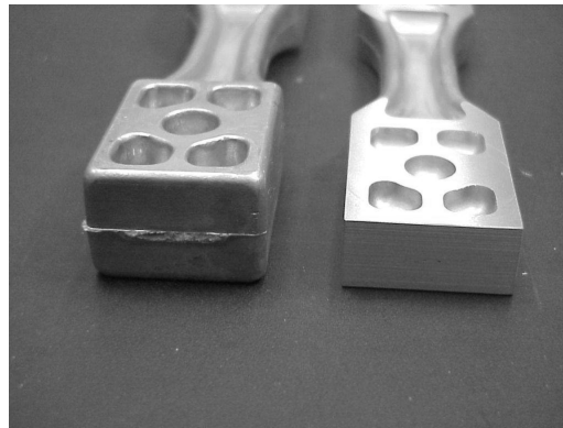
Figure 10.1 – L'éprouvette avant et après usinage.
