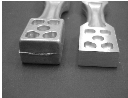
Figure 10.1 – L'éprouvette avant et après usinage.
