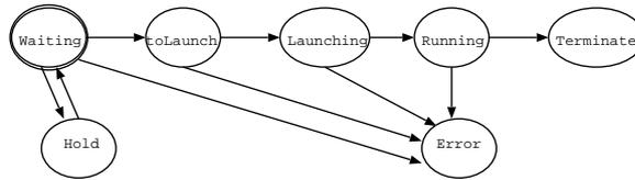
FIG. 2 – Diagramme d'état des tâches dans le système.
