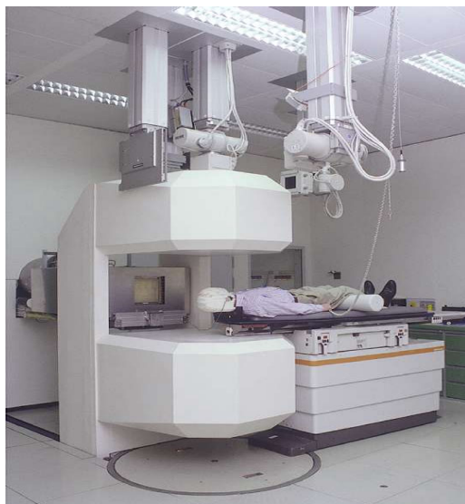
Figure 7 : Salle de traitement par hadronthérapie montrant la disposition des détecteurs TEP autour du patient pendant l'irradiation par faisceau d'ions carbone. (photographie: A. Zschau, GSI Darmstadt)
