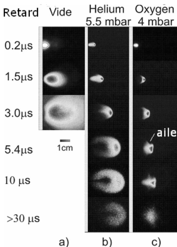
**Figure 1.** Images de l'expansion de la plume prises par caméra rapide iCCD à divers instants par rapport au début de l'impulsion laser d'ablation : a) Vide  $2 \cdot 10^{-7}$  mbar ; b) Pression d'hélium 5,5 mbar ; c) Pression d'oxygène 4 mbar. (Fluence laser  $F = 3,5\text{ J/cm}^2$  ). La cible est située à bord gauche des photographies.
