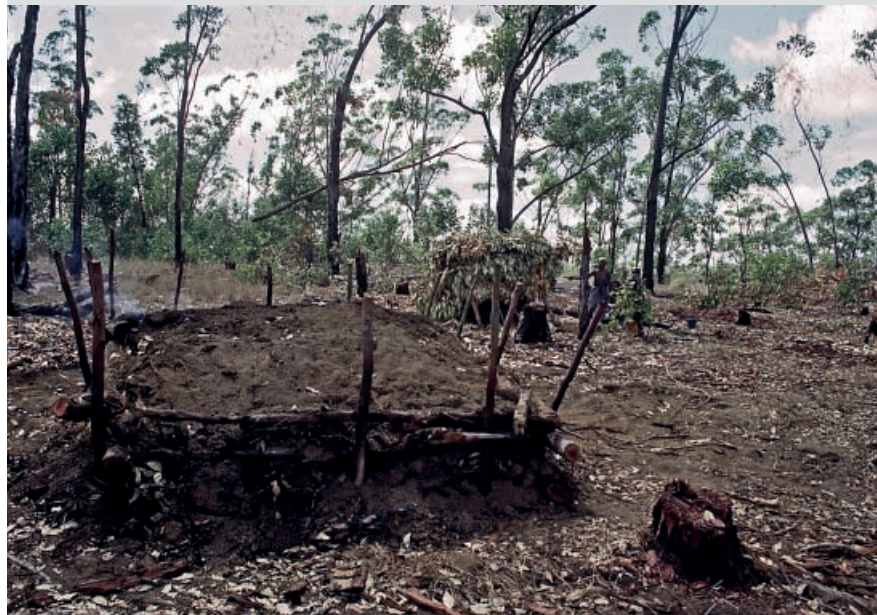
Meule à charbon de bois d' Eucalyptus robusta , lac Alaotra en 1993, Madagascar. Photo J. Tassin.
