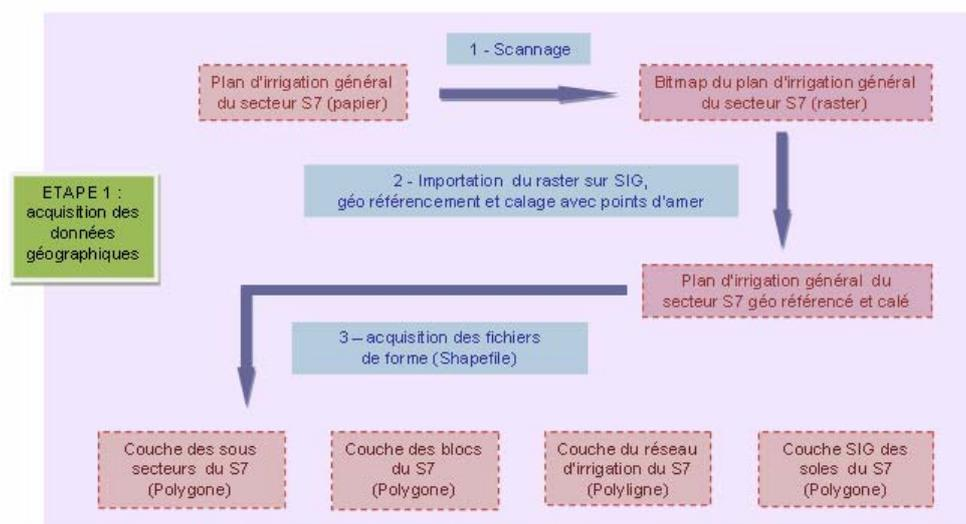
Figure 3. Méthode d'acquisition de nouvelles données géo référencées.
