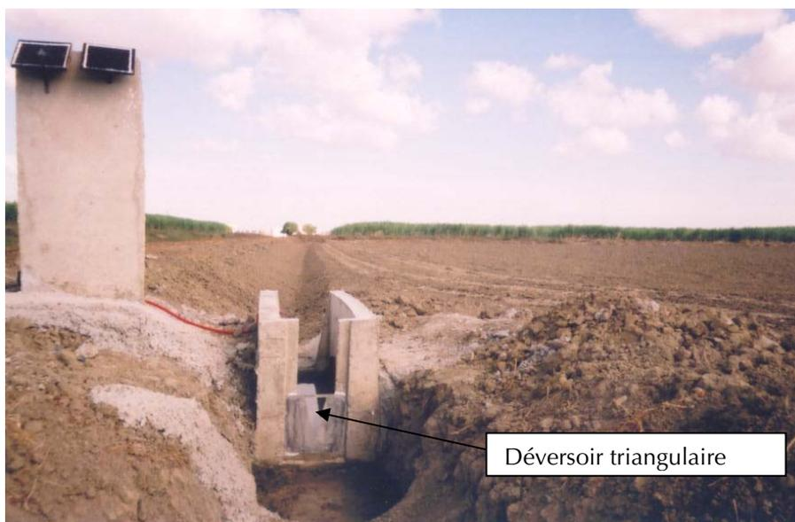
**Figure 2.** Bac déversoir pour le jaugeage des débits de ruissellement à l'aval de la parcelle gravitaire.
