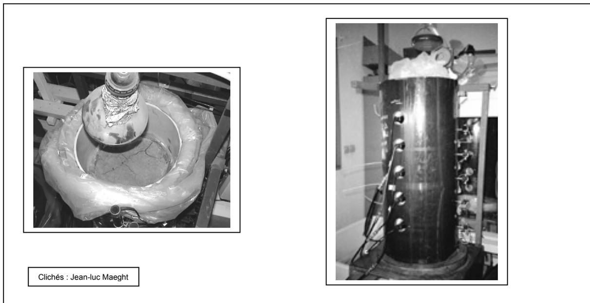
Après la mise en place, chaque colonne est équipée en appareillage de mesures standards et en capteurs spécifiques en fonction des objectifs d'expérimentations.
