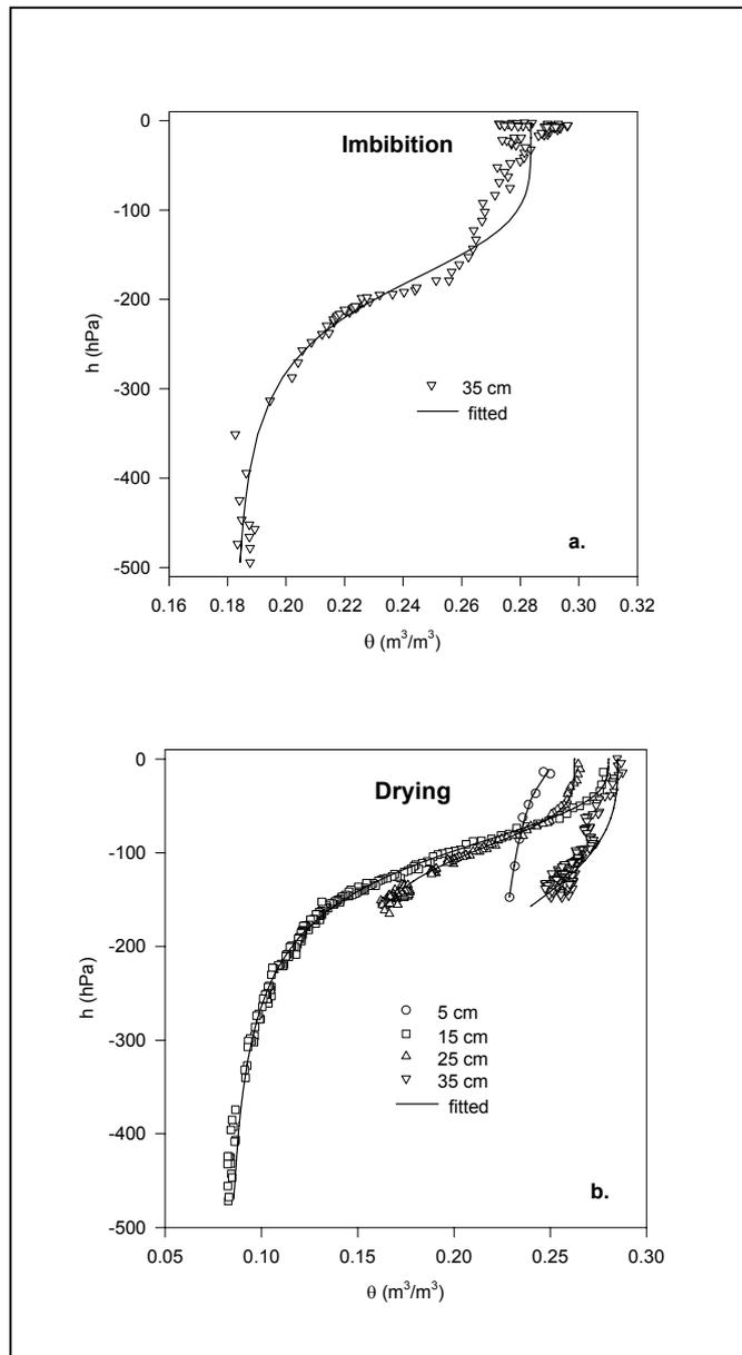
**Figure 5. Courbe de conductivité hydraulique pour différentes profondeurs, obtenue pendant la phase de séchage, et ajustée avec les paramètres hydrauliques de vanGenuchten**
