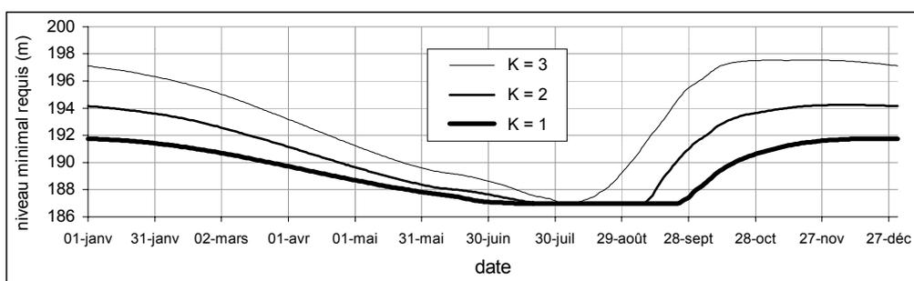
**Figure 11.** Niveau minimal à respecter dans la retenue pour permettre d'effectuer le soutien d'étiage désiré (pour des besoins en irrigation égaux à une, deux ou trois (K = 1, 2 ou 3) fois les besoins actuels), avec un taux de réussite de 24 années sur 25 (période 1950-2000).
