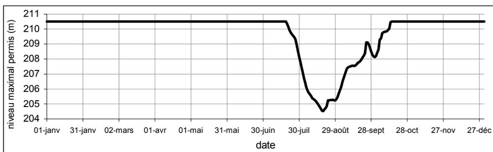
**Figure 10.** Niveau maximal à respecter dans la retenue pour permettre de laminier les crues du Sénégal à Bakel à 4 500 m<sup>3</sup>/s, avec un taux de réussite de 49 années sur 50 (période 1950-2000).
