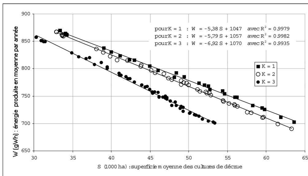
**Figure 14.** Relation entre la moyenne interannuelle de  $W$  (énergie produite par année) et celle de  $S$  (superficie annuelle de cultures de décrue), en fonction de  $K$  (taux d'augmentation des besoins en eau de l'irrigation par rapport aux besoins actuels) pour l'ensemble des scénarios de gestion testés.
