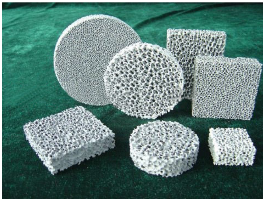
Exemple de mousses métalliques servant de support catalytique
