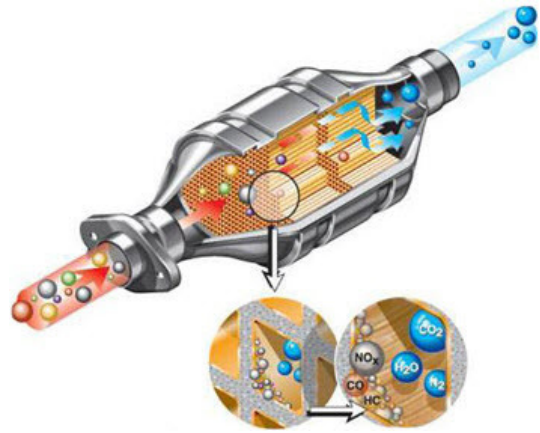
Schéma du fonctionnement d'un pot catalytique
