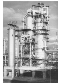
Réacteurs en lit fluidisé : on du contact catalytique dans le réacteur R-2, la partie droite de l'unité correspond aux deux étages de régénération successifs par l'ensemble des cyclones externes. (Phonologie I.P.P.)
