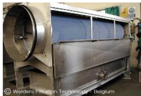
Figure 22 : Tables d'égouttage & tambour épaisseur.
