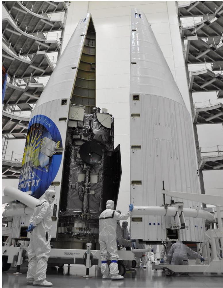
Installation de SDO dans la tête de la fusée Atlas (©SDO/NASA).
