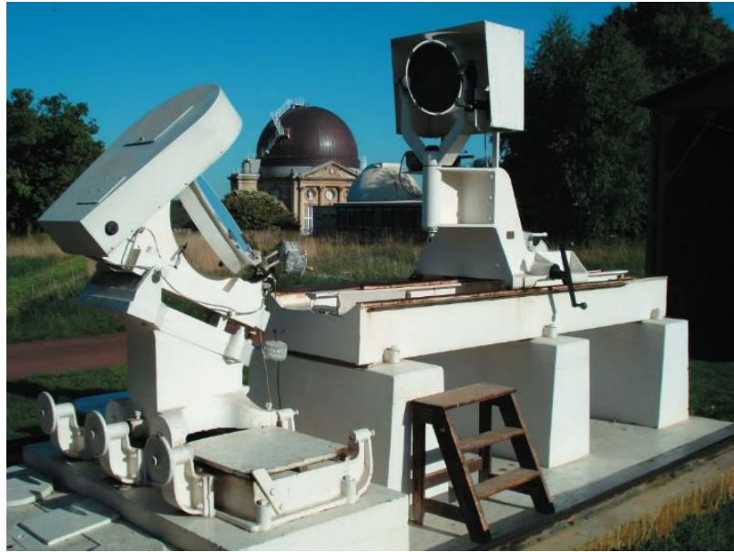
Le spectrohéliographe est alimenté par un système à deux miroirs appelé coélostat, comportant un miroir mobile qui suit le Soleil dans son mouvement diurne et compense la rotation terrestre (©OP).
