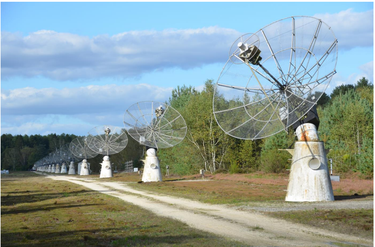
Radiohéliographe de Nançay composé de 47 antennes opérant dans la bande de fréquences radio de 150 à 450 méga Hertz, et délivrant des images de la couronne solaire (©OP).
