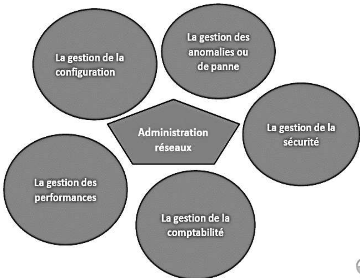
Modèle de fonctionnel d'administration selon OSI
