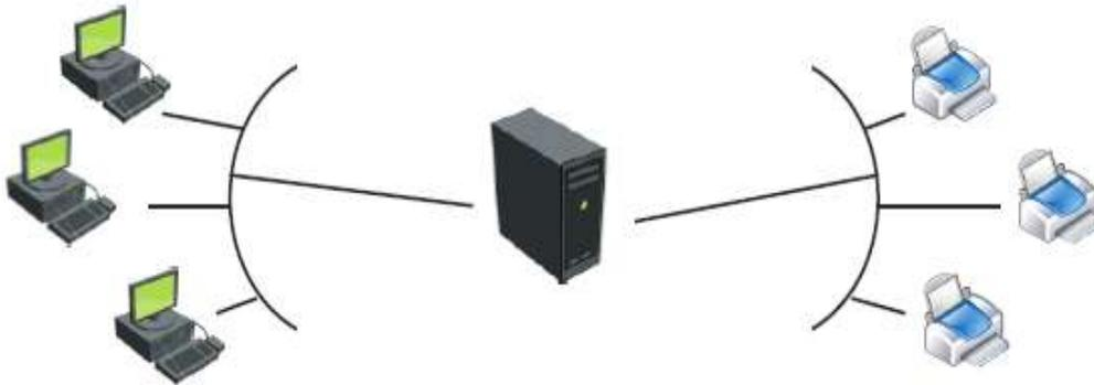
**Figure 3. Modèle Client-serveur d'impression**
