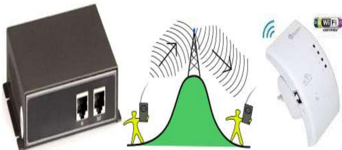
*Schéma d'un répéteur filaire & non filaire*
