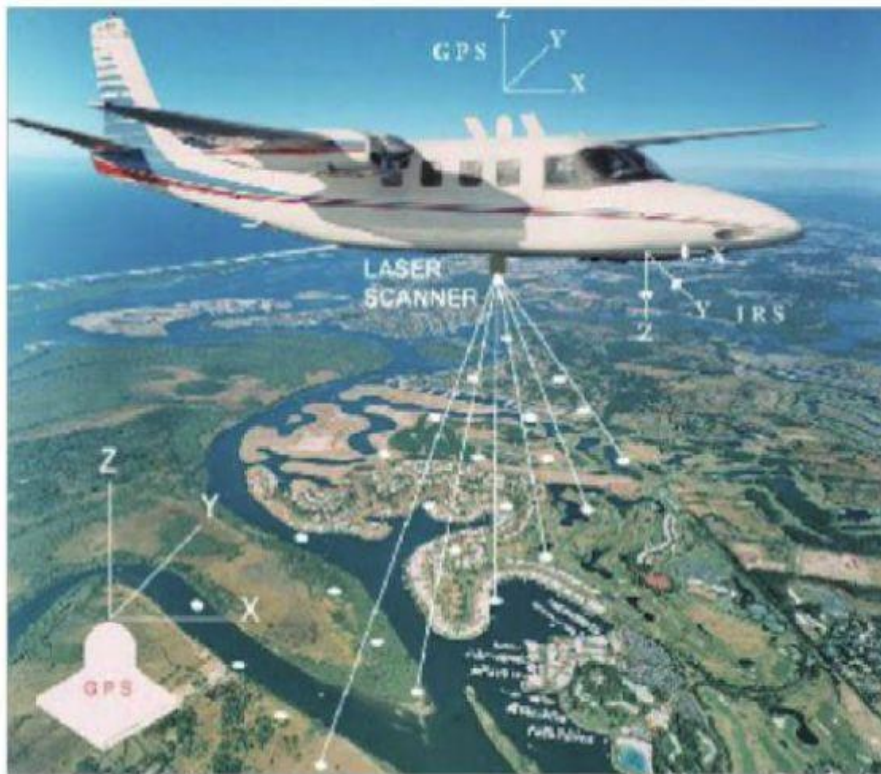
Figure VI.9 : Principe de l'acquisition de l'altimétrie par balayage laser.
