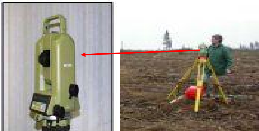
Figure II.7 : Exemple d'un théodolite.
