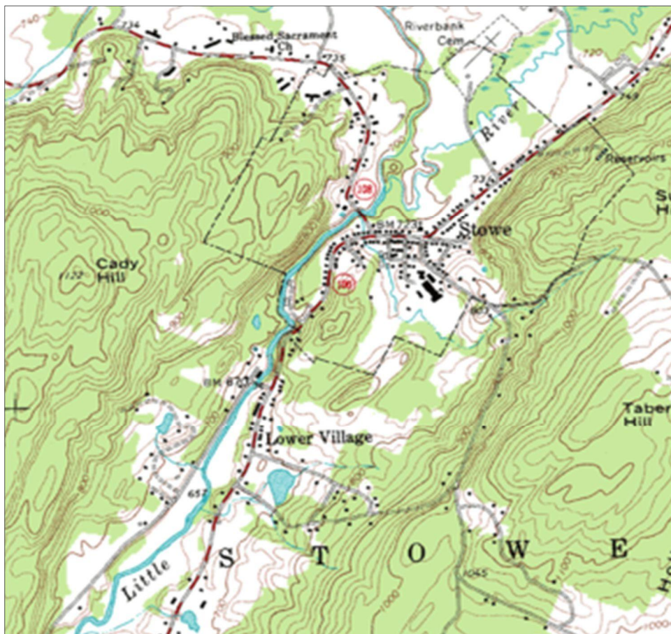
Figure VI.5 : Une carte topographique américaine en courbes de niveau. Équidistance des courbes de 20 mètres.
