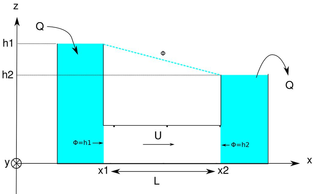
**Figure 4.1** – Schéma d'une expérience de filtration horizontale. Dans l'expérience originale de Darcy la filtration était verticale.
