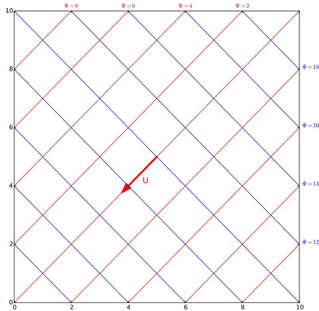
**Figure 4.2** – Courbes équipotentiels  $K\phi(x) = 10^{-4}(x + 2y) = C_e \text{ m}^2/\text{s}$  (bleu), lignes de courant  $\psi(x, y) = 10^{-4}(2x - y) = C_c \text{ m}^2/\text{s}$  (rouge) et vitesse de l'écoulement. la vitesse est définie par  $\mathbf{U} = -10^{-4}\mathbf{i} - 2 \cdot 10^{-4}\mathbf{j}$ . Elle a pour norme  $\|\mathbf{U}\| = \sqrt{5} \cdot 10^{-4} \text{ m/s}$ .
