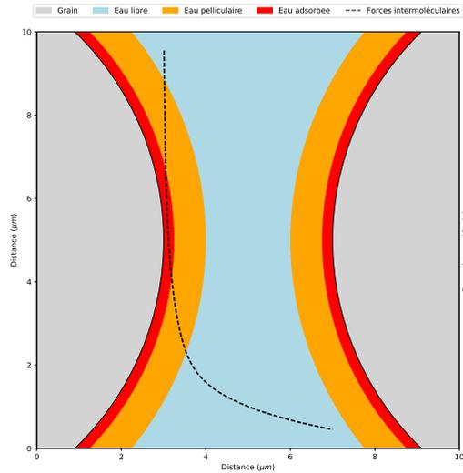
**Figure 1.1** – Structure de la couche d'eau entre deux particules. Eau adsorbée et eau pelliculaire forment ce que l'on appelle l'eau de rétention (d'après [10]).
