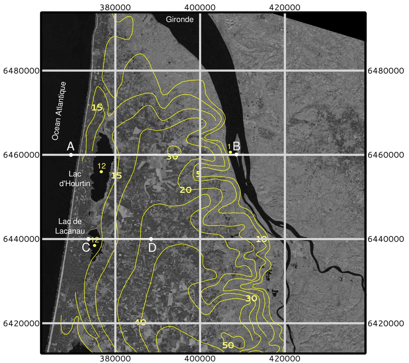
**Figure 14.5** – Image Landsat 8 de la région des lacs médocains sur laquelle sont superposés les isopièzes de la nappe des sables des landes, de Castets et des sables dunaires. La grille de coordonnées des latitudes et longitudes est donnée en mètres. Les cotes sont données en mètres au dessus du niveau de la mer. source des données : [4] et SIGES Aquitaine.
