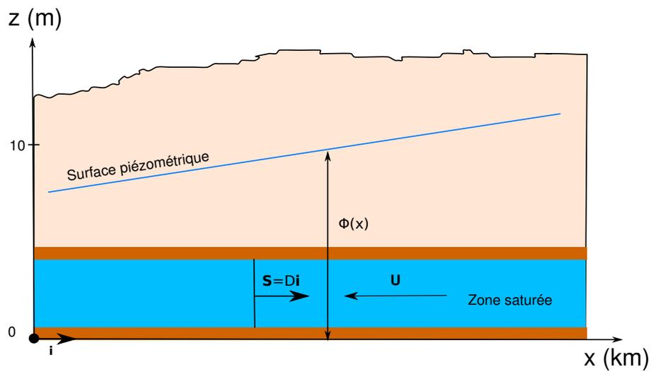
Figure 5.1 – Écoulement dans une nappe captive
