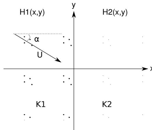
Figure 11.3 – Écoulement dans des milieux de perméabilité différente
