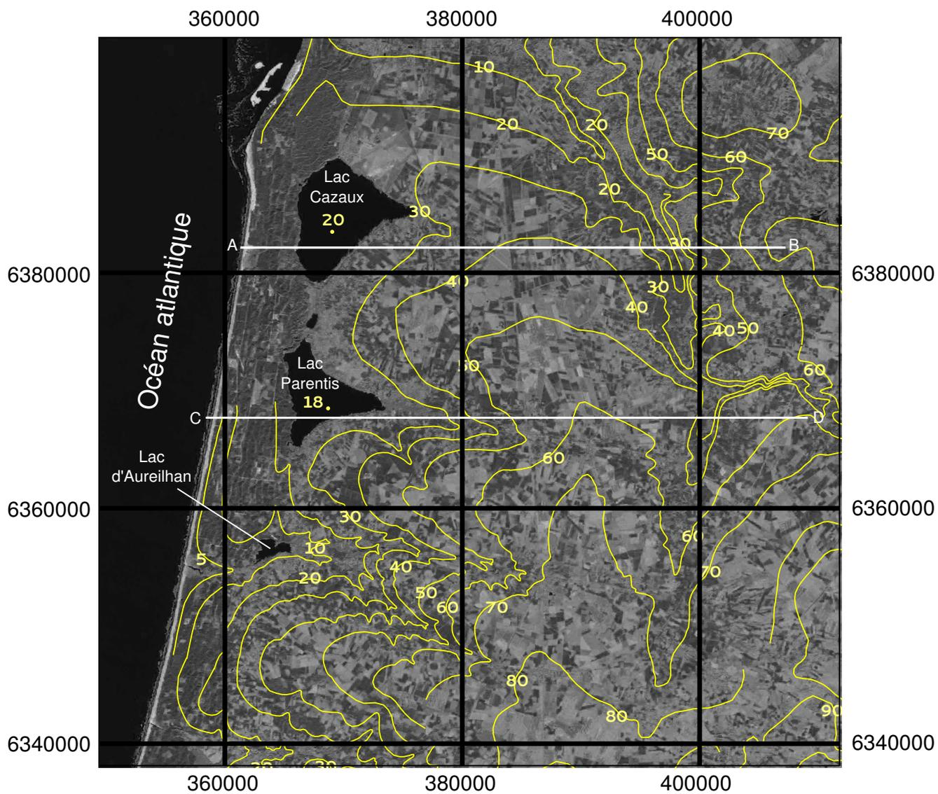
**Figure 14.8** – Image Landat 8 de la région de Biscarosse sur laquelle sont superposés les isopièzes de la nappe des sables des landes, de Castets et des sables dunaires. La grille de coordonnées des latitudes et longitudes est donnée en mètres. Les cotes sont données en mètres au dessus du niveau de la mer. [4] et SIGES Aquitaine.
